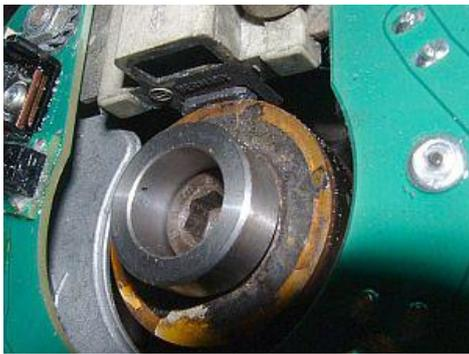
Abbildung 7 Montage des Stators und Mitnehmers.
