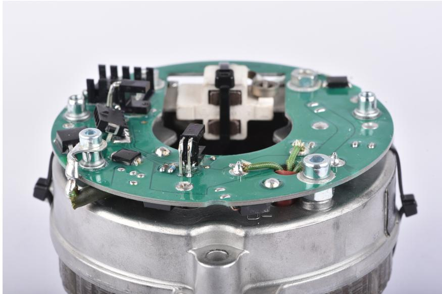
Abbildung 6 Montierter Regler
