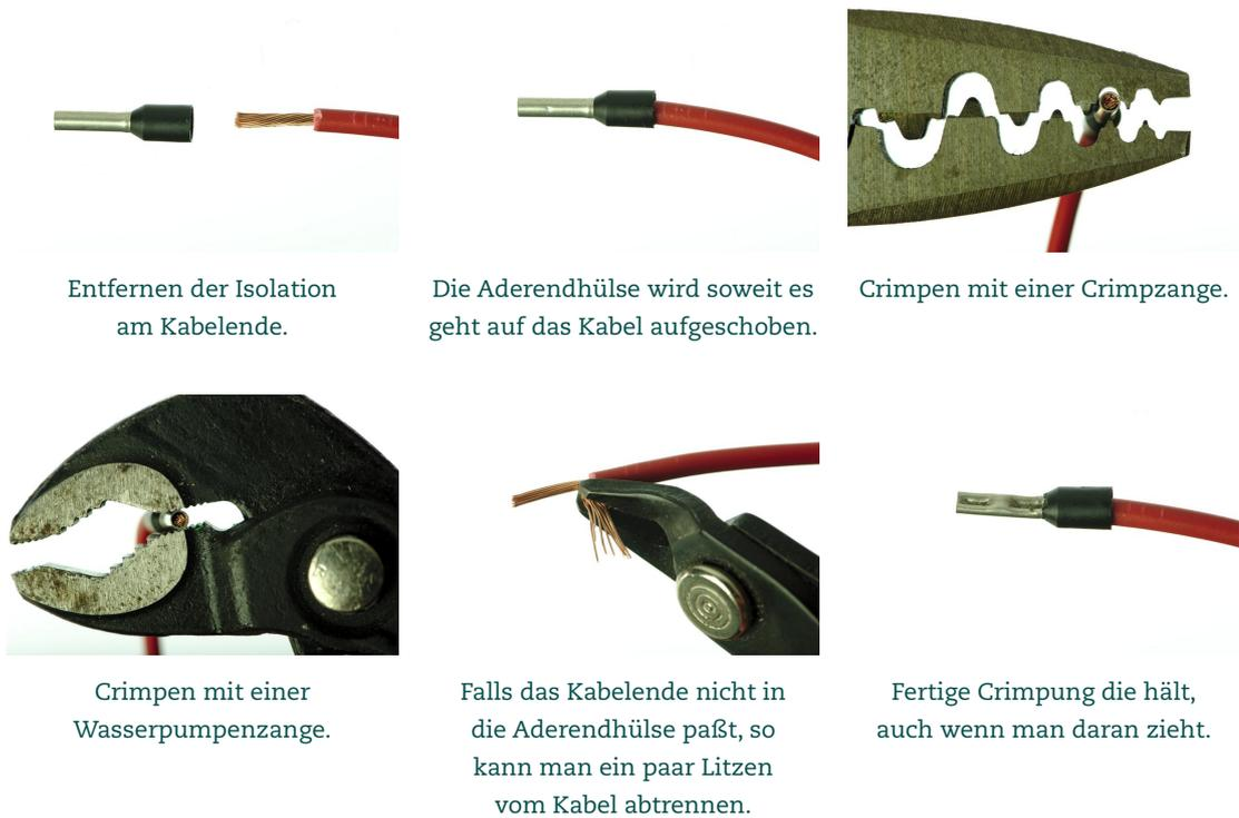
Abbildung 11 Crimpen der Aderendhülsen
