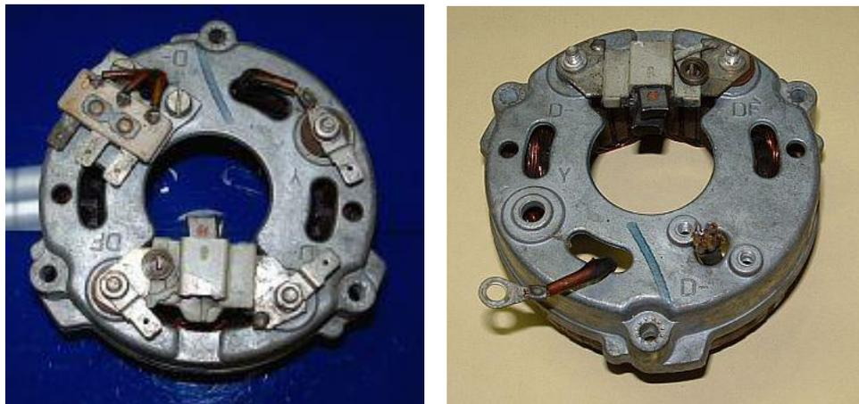
Abbildung 2 Entfernen des Anschlussblocks und der Y-Verbindung
