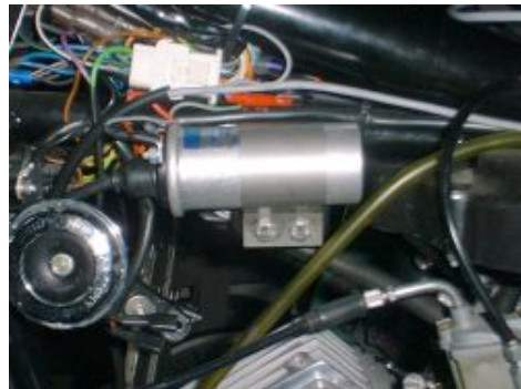
Abbildung 3 Montagevorschlag mit PVL220 Zündspule
