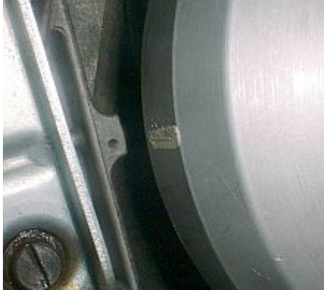
Abbildung 6.a Der hintere Kolben muß auf OT eingestellt werden.
