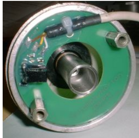
Abbildung 2.b Montage des Pickups (hier abgebildet ist eine ältere Version).
