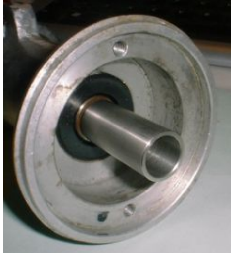
Abbildung 2.a Entfernen der alten Zündungskomponenten und Montage des Mitnehmers.
