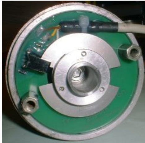
Abbildung 2.d Fertige eingebaute Zündung (ältere optische Variante ist hier abgebildet, die aktuelle nutzt Halleffectedsensoren und sieht etwas anders aus).
