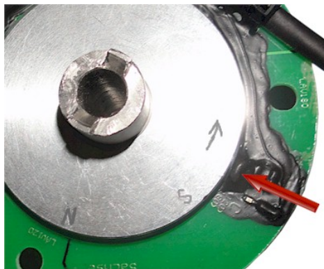
Abbildung 8 Dieser Sensor wird für die Grundeinstellung benutzt.
