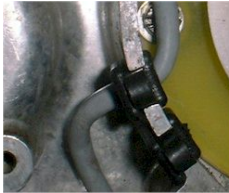
Abbildung 2 Das Anschlußkabel wird mit Hilfe der mitgelieferten Gummitülle durch das Motorgehäuse geleitet.
