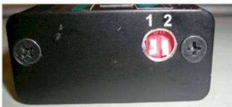
**Abbildung 4** DIP-Schalter und Zündkurvenauswahl.
