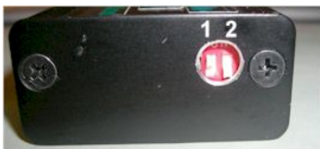
Abbildung 4 DIP-Schalter und Zündkurvenauswahl.
