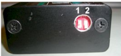
Abbildung 6 DIP-Schalter und Zündkurvenauswahl.
