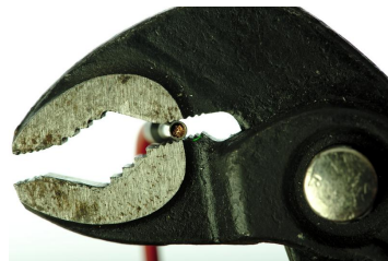
Crimpen mit einer Wasserpumpenzange.
