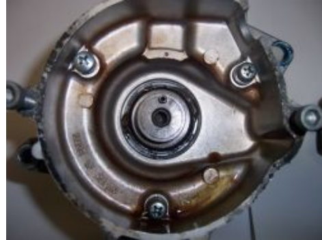
Abbildung 2 Mitnehmer montiert auf der Welle.
