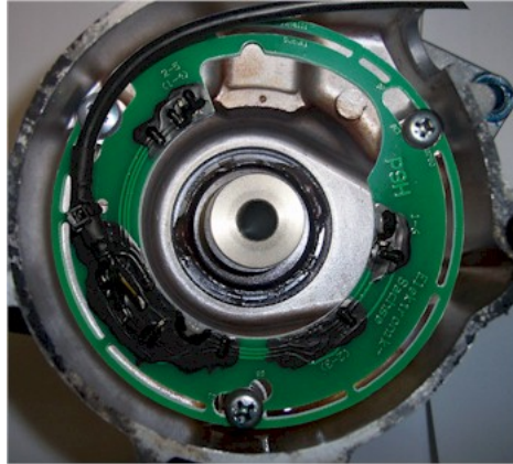
Abbildung 2.d Montiertes Pickup und Mitnehmer. Der Magnetring ist noch nicht montiert.
