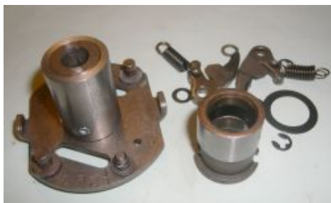
Abbildung 2 Entfernen der alten Zündungskomponenten. Der neue Mitnehmer wird über die Welle geschoben und befestigt.
