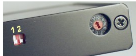
Abbildung 8 DIP-Schalter und Drehschalter.
