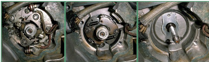
Abbildung 1 Zuerst die originale Kontaktplatte und den Fliehkraftregler ausbauen.
