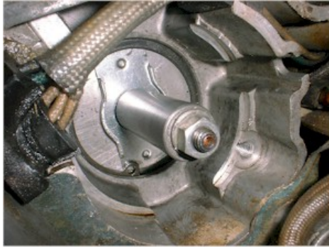
Als nächstes wird der Mitnehmer auf die Achse geschoben und mit der Mutter befestigt.
