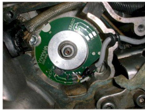
Zuletzt wird den Magnetring auf den Mitnehmer geschoben, aber die Madenschrauben in dem Magnetring noch nicht festziehen.
