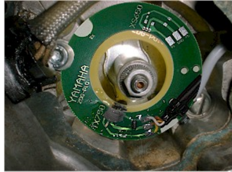
Danach erfolgt der Einbau der Leiterplatte.
