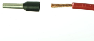
Entfernen der Isolation am Kabelende.
