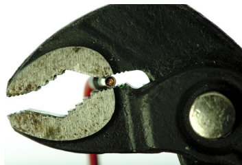
Crimpen mit einer Wasserpumpenzange.
