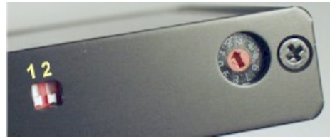
Abbildung 4 DIP-Schalter und Drehschalter.
