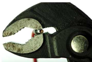
Crimpen mit einer Wasserpumpenzange.
