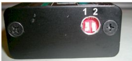
Abbildung 4 DIP-Schalter und Zündkurvenauswahl.
