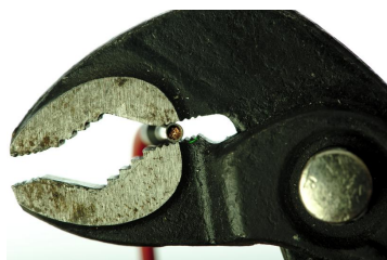
Crimpen mit einer Wasserpumpenzange.
