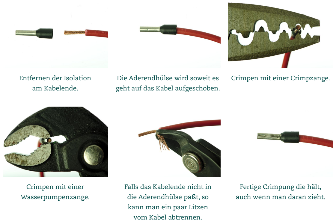
Abbildung 1 Crimpen der Aderendhülsen
