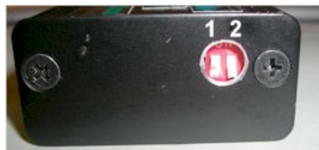
Abbildung 3 DIP-Schalter und Zündkurvenauswahl.
