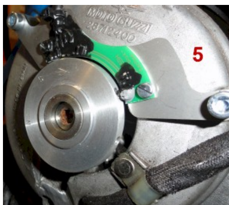
Installation des Magnetringes
