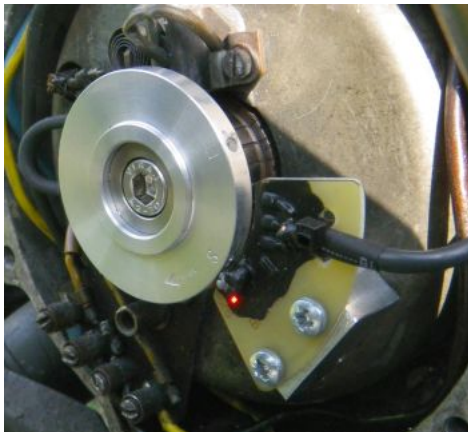
Die Montage der Zündbox kann a) in der Lampe oder b) unter dem Tank erfolgen.
