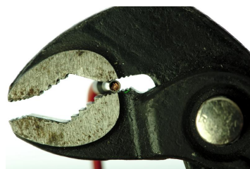
Crimpen mit einer Wasserpumpenzange.
