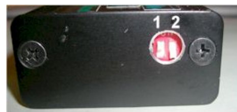
Abbildung 3 DIP-Schalter und Zündkurvenauswahl.
