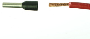
Entfernen der Isolation am Kabelende.
