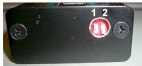
Abbildung 3 DIP-Schalter und Zündkurvenauswahl.
