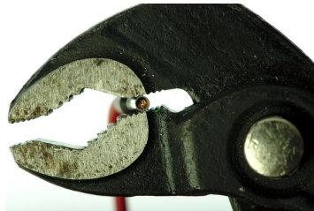
Crimpen mit einer Wasserpumpenzange.
