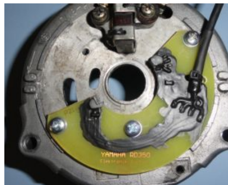
Montage der Sensorplatte auf der Alu-Lichtmaschine
