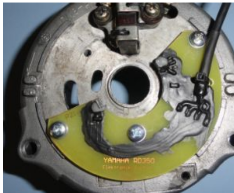
Montage der Sensorplatte auf der Alu-Lichtmaschine
