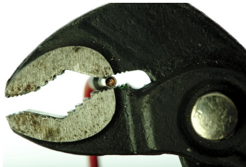
Crimpen mit einer Wasserpumpenzange.
