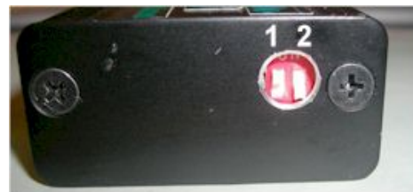
Abbildung 6 DIP-Schalter und Zündkurvenauswahl.
