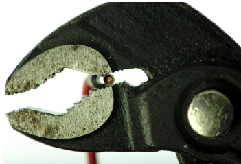
Crimpen mit einer Wasserpumpenzange.
