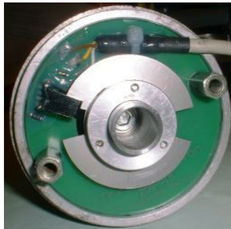
Abbildung 2 Fertig eingebaute Zündung (ältere optische Variante ist hier abgebildet, die aktuelle nutzt Halleffectedsensoren und sieht etwas anders aus).
