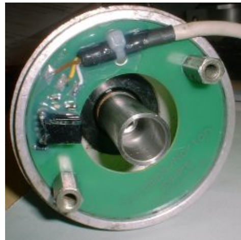
Abbildung 2 Montage des Pickups (hier abgebildet ist eine ältere Version).
