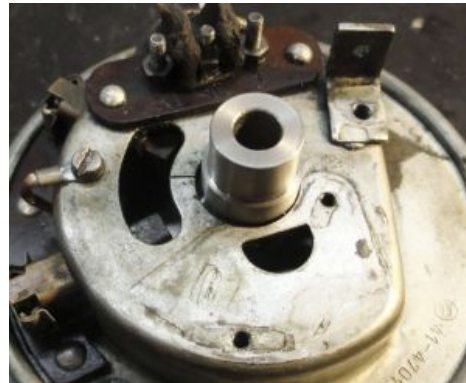
Den Mitnehmer auf den Rotor stecken und mit der Zentralschraube befestigen.
