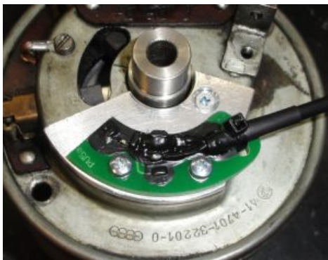
Die Sensorplatte mit den beiden M3-Schrauben montieren.
