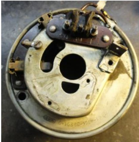
Den Fliehkraftregler und die Kontaktplatte komplett entfernen, auch den Filz.
