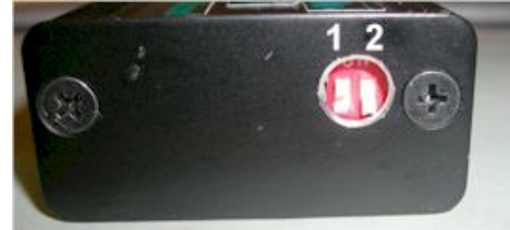
Abbildung 4 DIP-Schalter und Zündkurvenauswahl.
