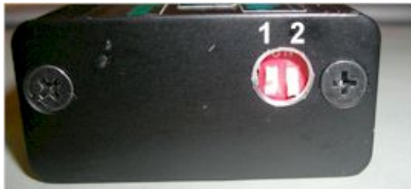
Abbildung 4 DIP-Schalter und Zündkurvenauswahl.
