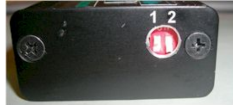
Abbildung 4 DIP-Schalter und Zündkurvenauswahl.
