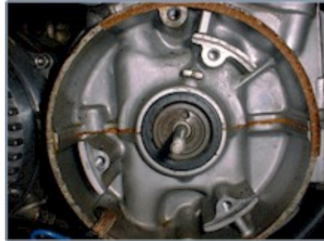
Abbildung 2 Entfernen des original Mitnehmers, damit unser Mitnehmer montiert werden kann.
