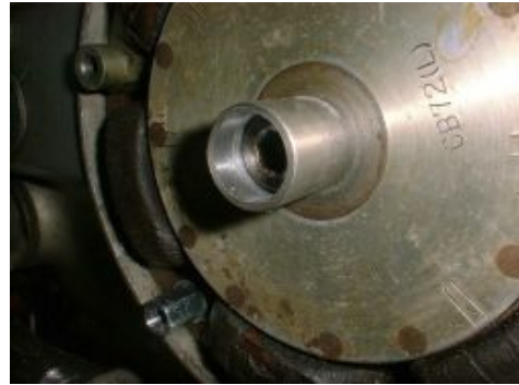
Abbildung 2.b Montage des Mitnehmers.
