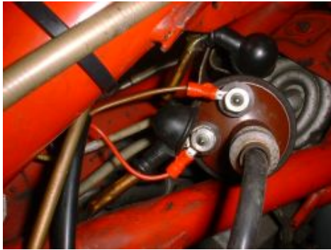
Abbildung 3 Montagevorschlag der rechten Zündspule.
