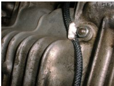
Abbildung 2 Schutz des Pickupkabels.
