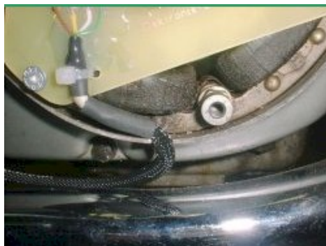
Abbildung 2 Führen des Pickupkabels durch den Ausschnitt.
