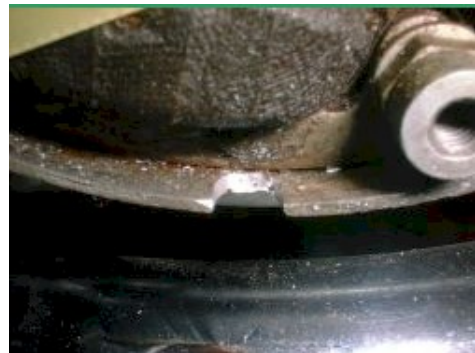
Abbildung 2 Ausschnitt für das Pickupkabel.
