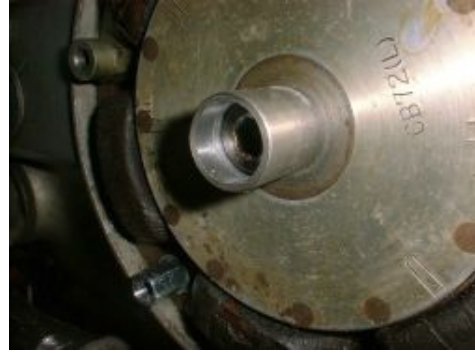
Abbildung 2 Montage des Mitnehmers.
