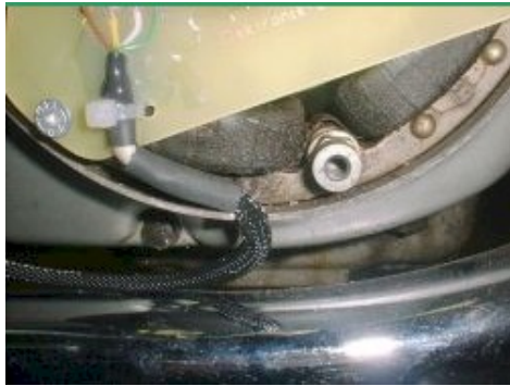
Abbildung 2 Führen des Pickupkabels durch den Ausschnitt.
