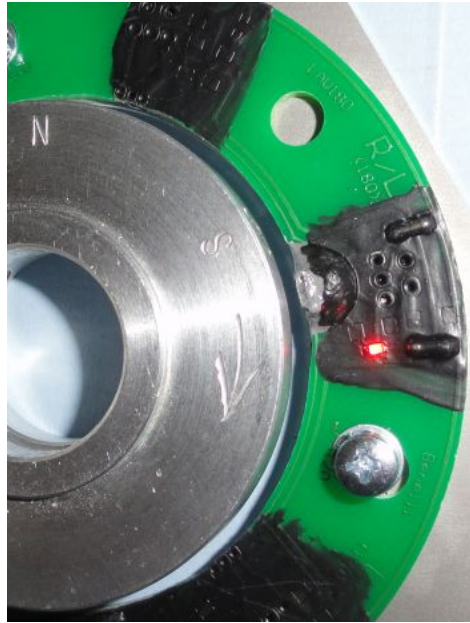
Abbildung 9 Dieser Sensor wird für die Grundeinstellung benutzt.
