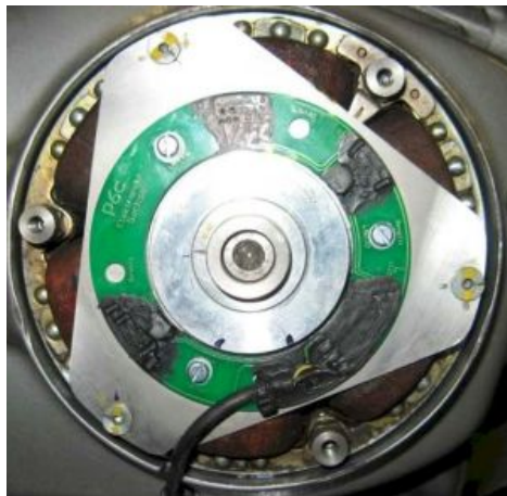
Abbildung 2 Montage des Pickups (das Bild zeigt eine ältere Version, die aktuelle sieht etwas anders aus).
