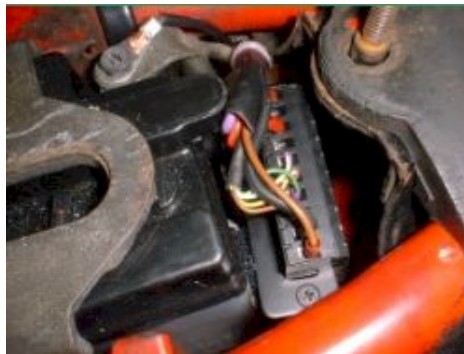
Abbildung 2 Vorschlag zur Montage der Zündbox.
