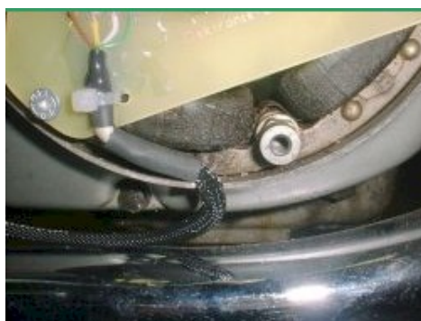
Abbildung 2.g Führen des Pickupkabels durch den Ausschnitt.
