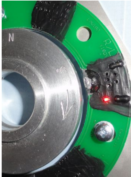
Abbildung 9 Dieser Sensor wird für die Grundeinstellung benutzt.
