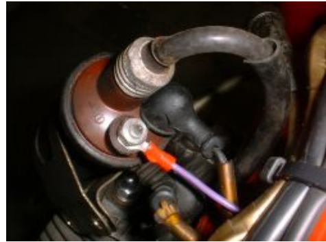
Abbildung 3 Montagevorschlag der linken Zündspule.
