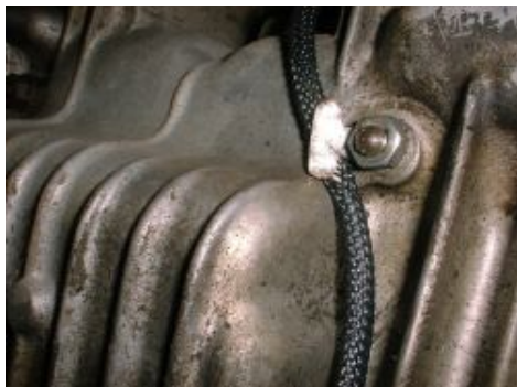
Abbildung 2 Schutz des Pickupkabels.
