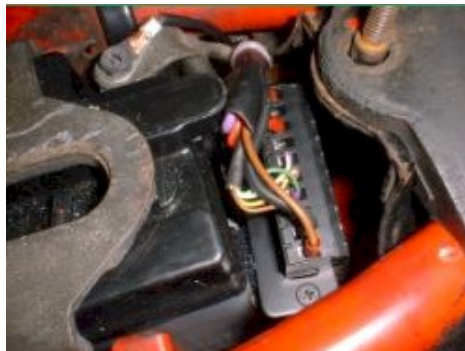
Abbildung 2 Vorschlag zur Montage der Zündbox.
