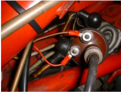
Abbildung 3.a Montagevorschlag der rechten Zündspule.
