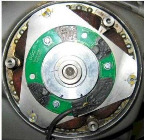
Abbildung 2.d Montage des Pickups (das Bild zeigt eine ältere Version, die aktuelle sieht etwas anders aus).
