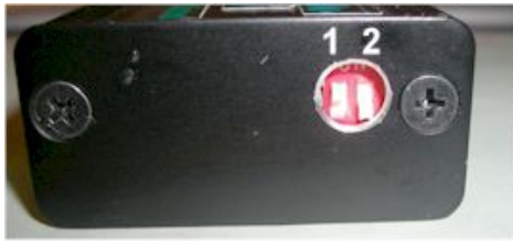
Abbildung 4 DIP-Schalter und Zündkurvenauswahl.
