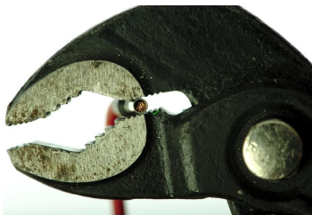
Crimpen mit einer Wasserpumpenzange.
