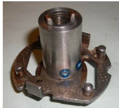
Abbildung 2 Mitnehmer montiert auf der Welle der Trägerplatte.
