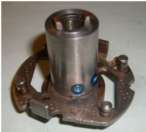
Abbildung 2 Mitnehmer montiert auf der Welle der Trägerplatte.
