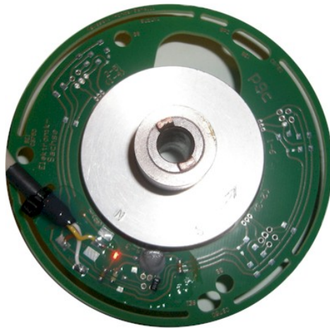
Abbildung 7 Pickup mit Mitnehmer und Magnetring.
