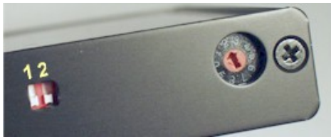
Abbildung 8 DIP-Schalter und Drehschalter.
