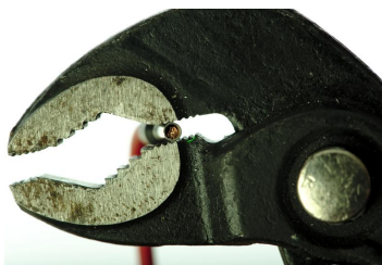
Crimpen mit einer Wasserpumpenzange.
