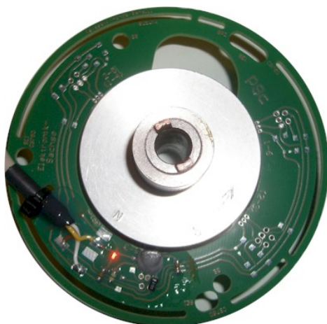
Abbildung 7 Pickup mit Mitnehmer und Magnetring.
