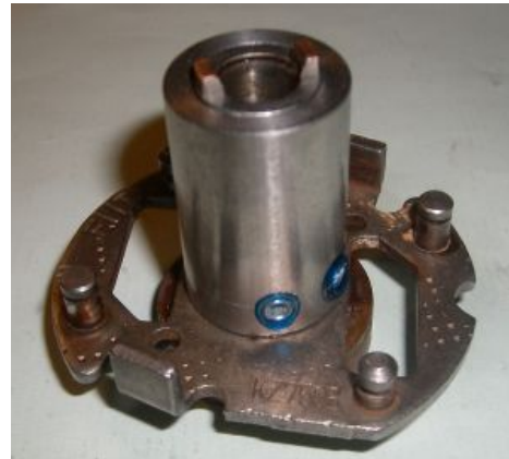
Abbildung 2 Mitnehmer montiert auf der Welle der Trägerplatte.
