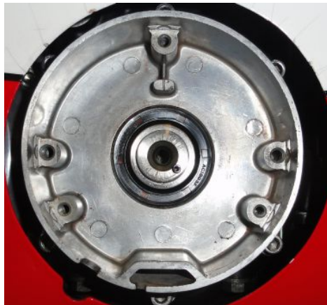
Abbildung 2 Entfernen der alten Zündung.
