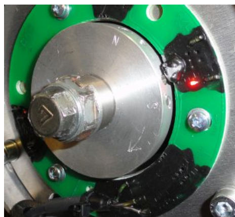
Abbildung 8 Die LED geht an wenn der S-Magnet am Sensor vorbeiläuft.
