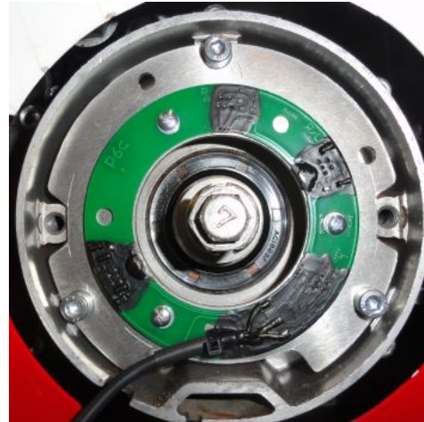
Abbildung 2 Montage des neuen Pickup auf der Trägerplatte.
