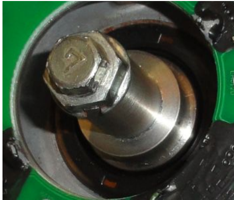
Abbildung 2 Montage des Mitnehmers.
