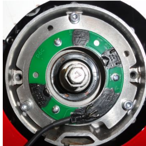
Abbildung 2 Montage des neuen Pickup auf der Trägerplatte.
