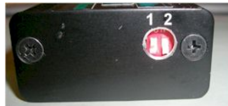
Abbildung 4 DIP-Schalter und Zündkurvenauswahl.
