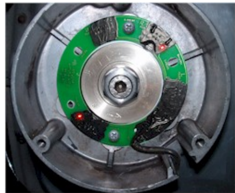
Abbildung 2 Komplette Montage von Pickup, Mitnehmer und Magnetring.
