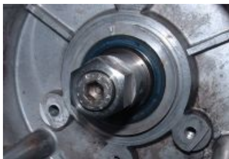
Abbildung 2.d Der Mitnehmer wird mittels Zentralschraube befestigt.
