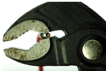
Crimpen mit einer Wasserpumpenzange.
