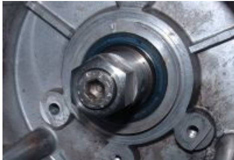
Abbildung 2 Der Mitnehmer wird mittels Zentralschraube befestigt.
