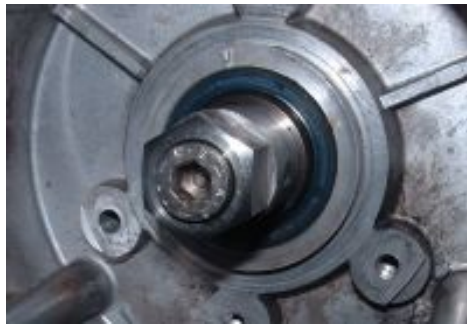
Abbildung 2 Der Mitnehmer wird mittels Zentralschraube befestigt.
