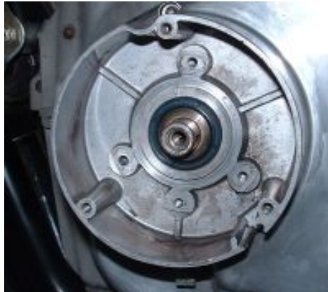
Abbildung 2 Entfernen der alten Zündungskomponenten.
