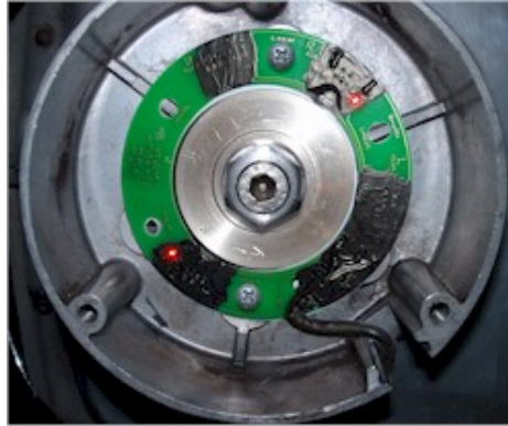
Abbildung 2 Komplette Montage von Pickup, Mitnehmer und Magneting.
