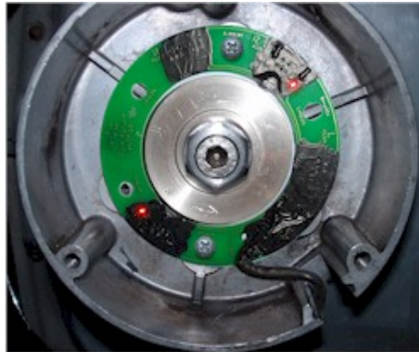
Abbildung 2 Komplette Montage von Pickup, Mitnehmer und Magneting.
