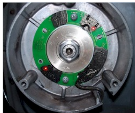
Abbildung 2.e Komplette Montage von Pickup, Mitnehmer und Magnetring.
