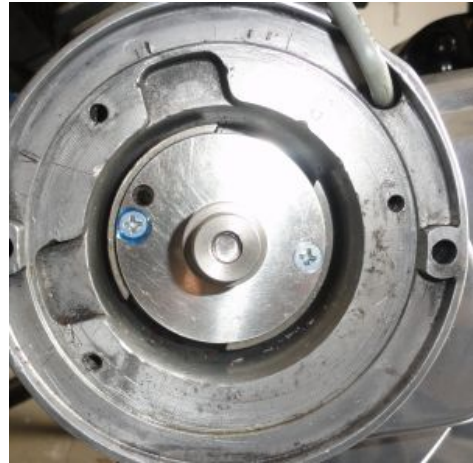
Abbildung 2 Montage des Mitnehmers.
