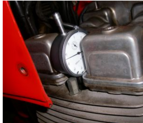
Abbildung 6 Meßuhr um den OT genau zu bestimmen.
