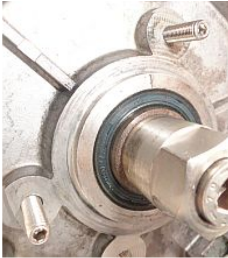
Abbildung 2 Montage der Gewindestifte.
