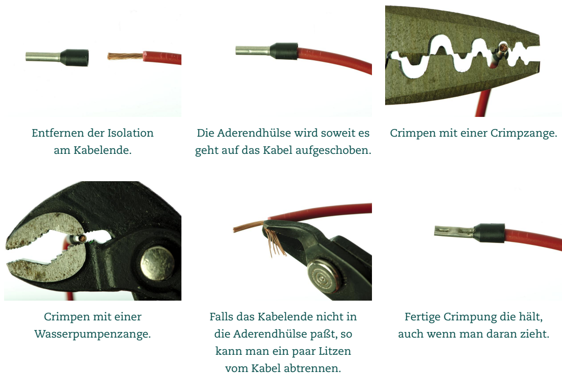
Abbildung 4 Crimpen der Aderendhülsen
