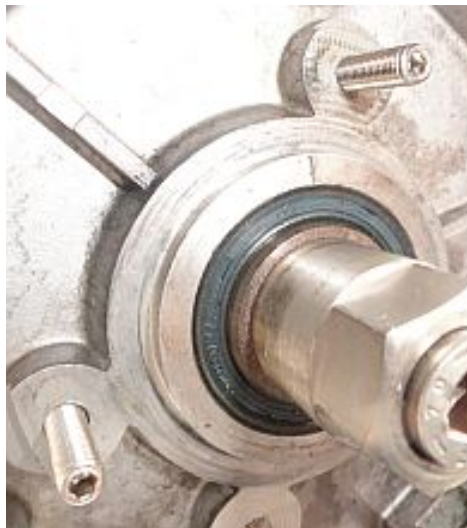
Abbildung 2.d Montage der Gewindestifte.
