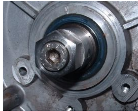
Abbildung 2.b Der Mitnehmer wird mit einer Zentralschraube befestigt.
