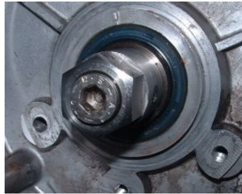
Abbildung 2 Der Mitnehmer wird mit einer Zentralschraube befestigt.
