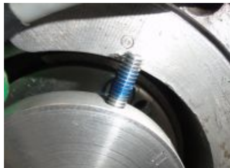
Abbildung 6.d Die Madenschrauben mit mittelfestem Schraubensicherungslack sichern.
