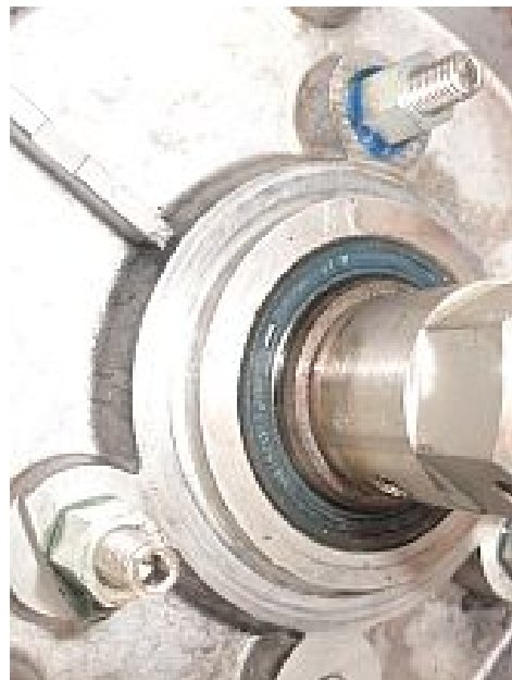
Abbildung 2.e Abstandshalter werden montiert.
