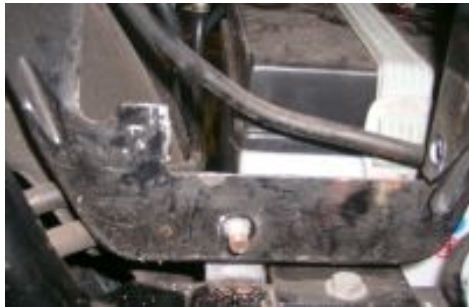
Abbildung 2 Montagevorschlag für die Zündbox.
