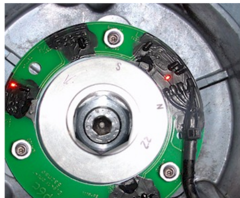
Abbildung 2 Komplette Montage von Distanzring, Pickup, Mitnehmer und Magnetring.
