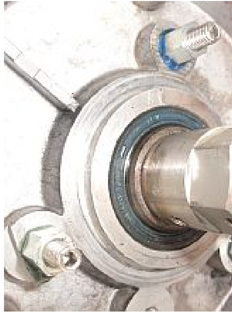
Abbildung 2 Abstandshalter werden montiert.
