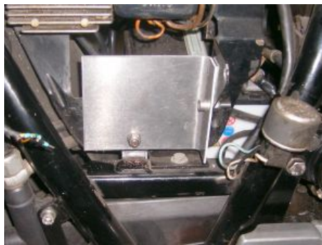
Abbildung 2 Halteplatte für die Zündbox.
