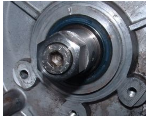
Abbildung 2 Der Mitnehmer wird mit einer Zentralschraube befestigt.
