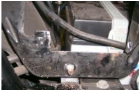
Abbildung 2 Montagevorschlag für die Zündbox.
