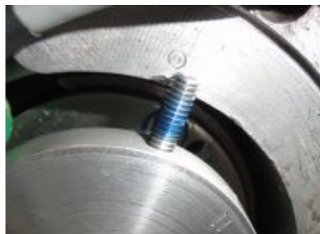
Abbildung 6 Die Madenschrauben mit mittelfestem Schraubensicherungslack sichern.
