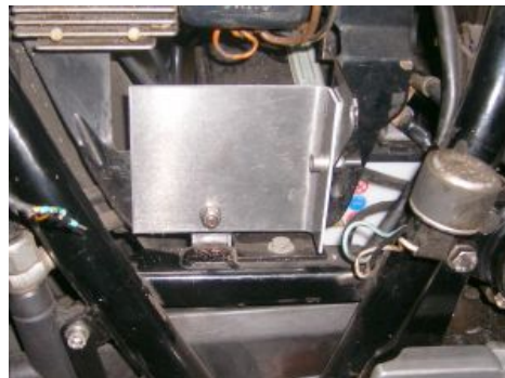
Abbildung 2 Halteplatte für die Zündbox.
