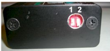
Abbildung 4 DIP-Schalter und Zündkurvenauswahl.
