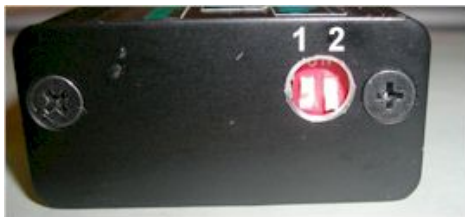
Abbildung 4 DIP-Schalter und Zündkurvenauswahl.
