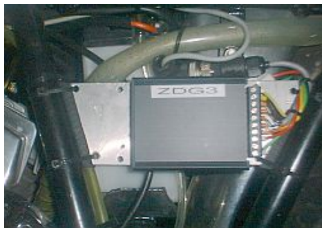
Abbildung 3 Montage der Zündbox
