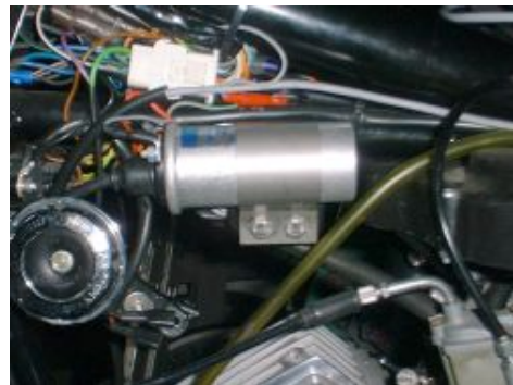
Abbildung 3 Montagevorschlag mit PVL220 Zündspule
