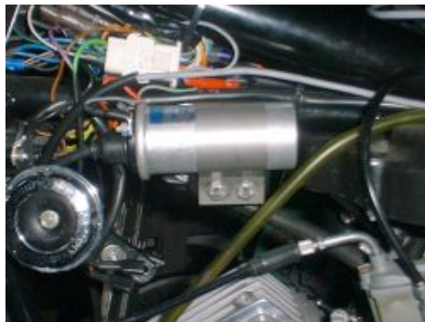
Abbildung 2 Montagevorschlag der Zündspulen PVL220.
