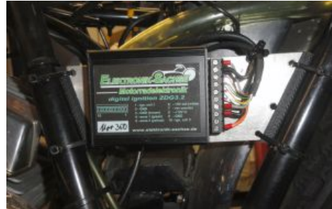
Abbildung 2 Montage der Zündbox im Rahmendreieck mit Hilfe eines Halteblechs.
