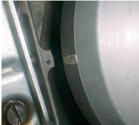
Abbildung 6 Der hintere Kolben muß auf OT eingestellt werden.
