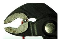
Crimpen mit einer Wasserpumpenzange.
