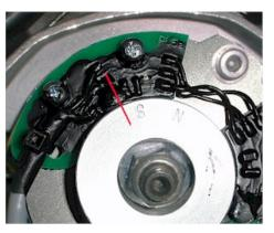
**Abbildung 6** Dieser Sensor wird für die Grundeinstellung benutzt.
