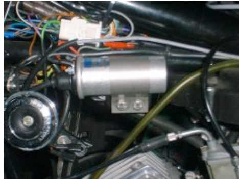
Abbildung 2 Montagevorschlag der Zündspulen PVL220.
