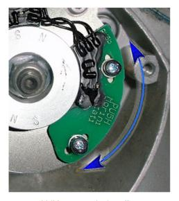
Abbildung 6 Feineinstellung des Versatzes der Frühzündung zwischen den beiden Zylindern.
