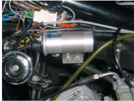
Abbildung 2.d Montagevorschlag der Zündspulen PVL220.
