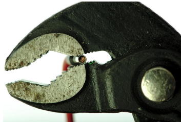
Crimpen mit einer Wasserpumpenzange.
