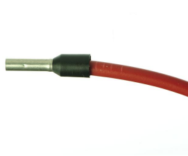
Die Aderendhülse wird soweit es geht auf das Kabel aufgeschoben.
