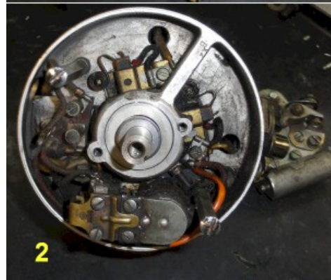
Abbildung 2 Die Komponenten der alten Zündung werden entfernt.
