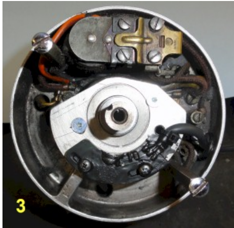
Abbildung 2 Montage des neuen Pickups.
