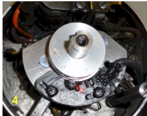
Abbildung 2 Montage des Magnetrings auf der Welle.
