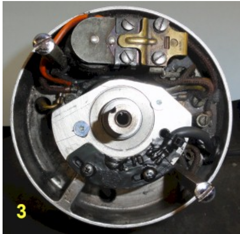
Abbildung 2 Montage des neuen Pickups.
