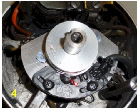
Abbildung 2.e Montage des Magnetrings auf der Welle.
