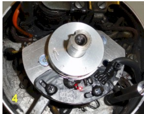
Abbildung 2 Montage des Magnetrings auf der Welle.
