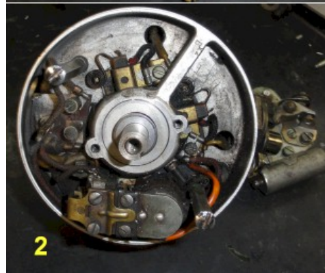
Abbildung 2 Die Komponenten der alten Zündung werden entfernt.
