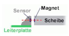
Abbildung 7 Korrekte Ausrichtung von Magnetring und Sensor.
