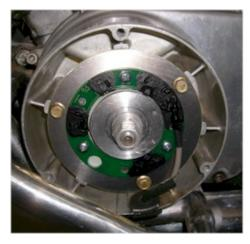
Abbildung 2 Komplette Montage von Pickup
