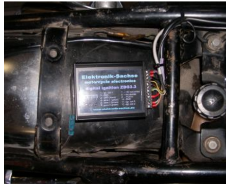
Abbildung 3 Montagevorschlag der Zündbox.
