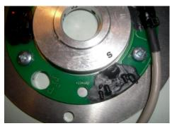
Abbildung 8 Die LED geht aus wenn der Kolben auf OT ist.
