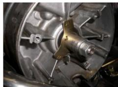
Abbildung 2 Entfernen der alten Zündungskomponenten.
