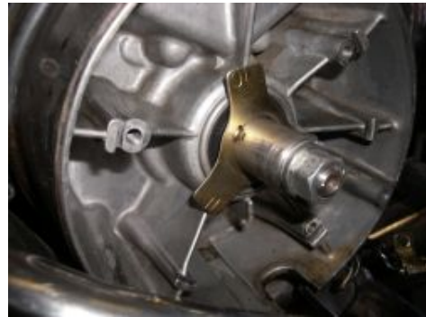
Abbildung 2 Entfernen der alten Zündungskomponenten.
