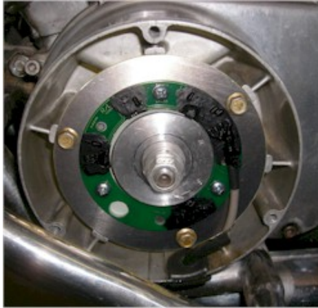
Abbildung 2 Komplette Montage von Pickup
