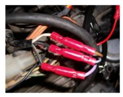
Abbildung 5 Zündspulenanschluß
