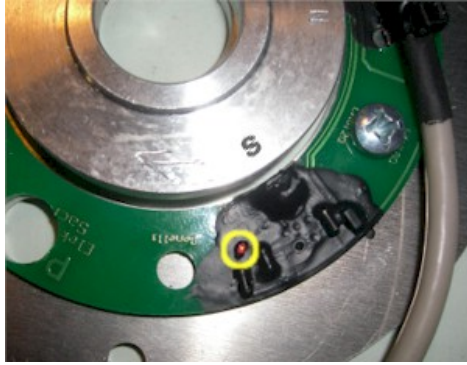
Abbildung 8 Dieser Sensor wird für die Grundeinstellung benutzt.
