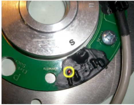
Abbildung 8 Dieser Sensor wird für die Grundeinstellung benutzt.
