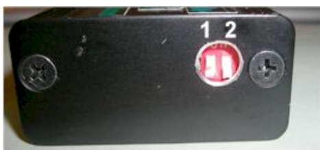
Abbildung 5 DIP-Schalter und Zündkurvenauswahl.
