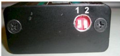
Abbildung 5 DIP-Schalter und Zündkurvenauswahl.
